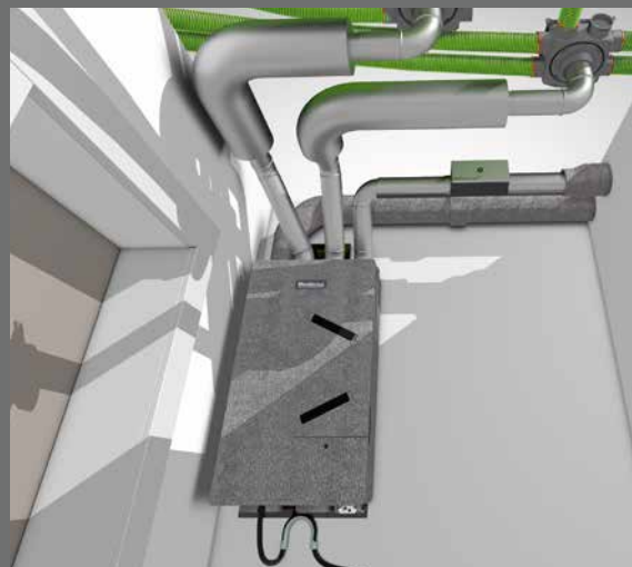
Inštaláčn situcia na stene (iba Logavent HRV156-100K)
